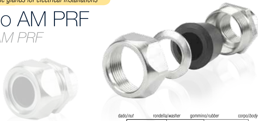
dado/nut rondella/washer gommino/rubber corpo/body
